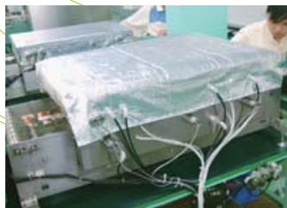
乾燥炉断熱用カバーの導入による空調負荷の低減 (天津アルプス)
