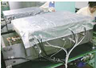
因引进了干燥炉隔热罩,从而降低了空调负荷(天津阿尔卑斯)
