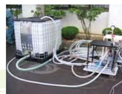
1999年に判明した、有機塩素系化合物による土壌・地下水汚染の浄化作業を継続的に実施しています。
