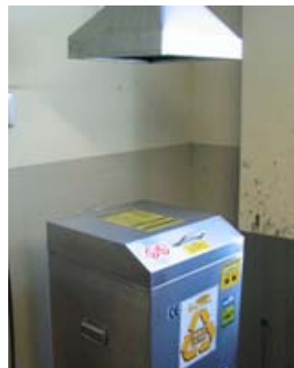
アセトン廃液を再生する蒸留装置
