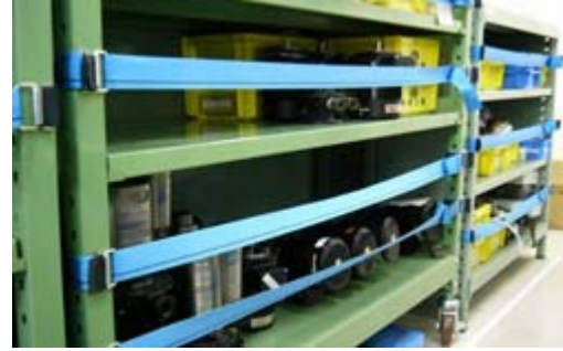
棚にベルトを取り付け、備品の飛び出しを防止
