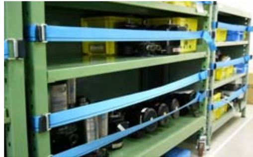
棚にベルトを取り付け、備品の飛び出しを防止
