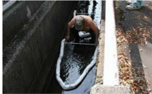
長岡工場(新潟県)にて、重油が漏洩したケースを想定し、対応手順・対策キットの作業性などを検証
