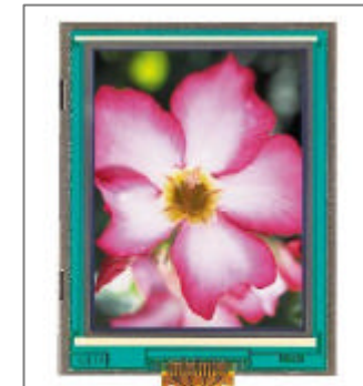
海外市場の携帯電話で採用が進む、色再現性の良いカラーSTN-LCD
