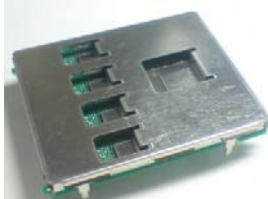
車載用フルセグチューナモジュール
