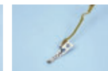
HDD用 TuMR 薄膜ヘッド 高密度記録化するHDD用に先端技術のヘッドの開発、量産をご紹介しました。
