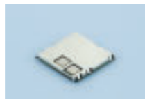
ワンセグ&3セグ対応チューナモジュール 携帯機器用に高画質の受信が可能な地上デジタル放送用チューナを開発しました。
