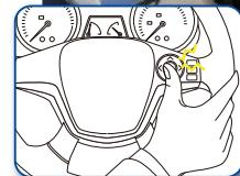
指先の検知や操作を振動でフィードバックするステアリングスイッチ。快適操作と安全性に貢献
