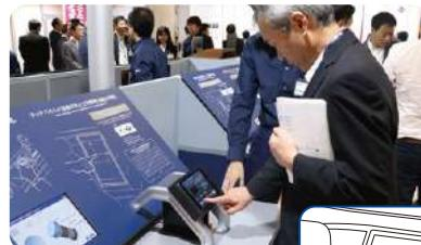
車載用タッチパネルにアナログブッシュスイッチを搭載。押し強さ(Z方向)を検出し、誤操作を防止
